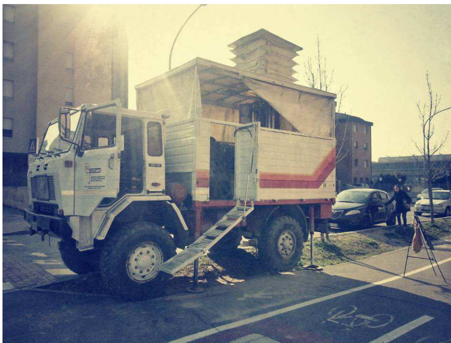
Fig.10: Penetrometro statico da 300 KN, montato su camion IVECO, utilizzato.
